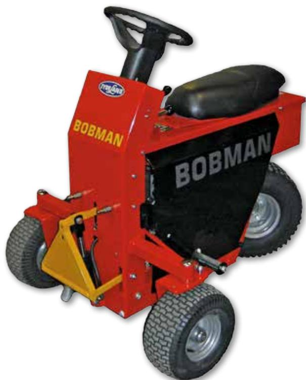
BOBMAN Pro ist eine kleine kompakte Maschine mit hydraulischem Antrieb, die imstande ist, je nach Bedarf verschiedene Geräte zu verwenden. Das bedeutet, dass sie imstande ist, die Geräte mit einem hydraulischen Hebearm zu heben und zu senken. BOBMAN Pro ist einfach zu bedienen und die Umrüstzeit beim Wechsel von einem Gerät zum anderen beträgt nur ca. 1 Minute.
