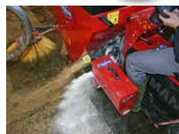
Trémie pour désinfectant - Capacité 10 l.
