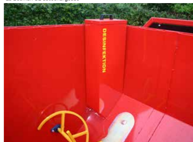
Trémie pour désinfectant - Capacité 30 l.
